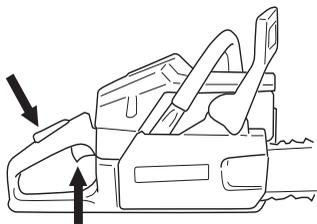
Cuando el motor encienda, oprima inmediatamente el estrangulador y repita los intentos de arranque hasta que el motor se ponga en marcha. Cuando arranque el motor, acelere al máximo y se desacoplará automáticamente la aceleración de arranque.
