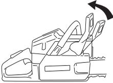
Desenrosque las tuercas de la espada y saque la cubierta del embrague (el freno de cadena). Saque la protección de transporte (A).
