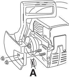
Monte la espada en los pernos. Sitúela en la posición posterior extrema. Monte la cadena en el piñón de arrastre y la guía de la espada. Empiece con la parte superior de la cadena. Compruebe que los filos de los eslabones de corte estén orientados hacia delante en la parte superior de la espada.
