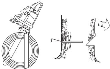
El corte de derribo debe quedar paralelo con la línea de corte de indicación, con una distancia mínima entre ambos de 1/10 del diámetro del tronco. La parte del tronco sin cortar se denomina faja de desgaje.
