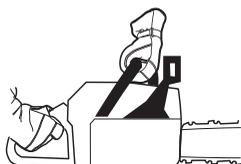
Acelere al máximo y active el freno de cadena girando la muñeca izquierda hacia la protección contra reculadas. No suelte el mango delantero. **La cadena debe detenerse inmediatamente.**
