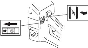
Si la máquina tiene una válvula de descompresión (A): oprima la válvula para reducir la presión en el cilindro y facilitar el arranque de la máquina. La válvula de descompresión debe utilizarse siempre para los
