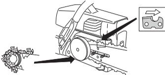
Monte la cubierta del embrague y ponga el vástago de tensado de cadena en el orificio de la espada. Compruebe que los eslabones de arrastre de la cadena encajen en el piñón de arrastre y que la cadena esté bien
