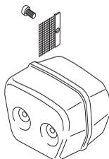
El silenciador está diseñado para amortiguar el ruido y para apartar del usuario los gases de escape. Los gases de escape están calientes y pueden contener chispas que pueden ocasionar incendios si se dirigen los gases a materiales secos e inflamables.
