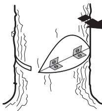
Se pierde completamente el control de la dirección de derribo del árbol si la faja de desgaje es demasiado
