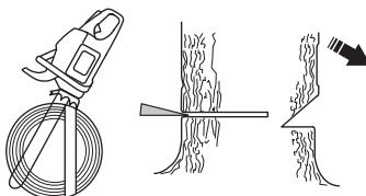
O corte de abate deverá terminar paralelamente à linha de corte direccional de modo que a distância entre ambos seja no mínimo de 1/10 do diâmetro do tronco. A parte não serrada no tronco é designada de linha de ruptura. A linha de ruptura funciona como uma dobradiça que comanda a direcção da queda da árvore.
