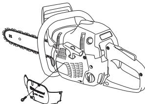
**¡IMPORTANTE!** Si se ha montado el conjunto especial de invierno o si se han tomado medidas para aumentar la temperatura, debe cambiarse al reglaje normal, puesto que la máquina funciona con temperatura normal. De lo contrario, hay riesgo de sobrecalentamiento con las consiguientes averías graves del motor.
