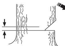
Coloque el apoyo de corteza (si ha sido montado) detrás de la faja de desgaje. Corte con aceleración máxima introduciendo lentamente la cadena/espada en el tronco. Preste atención a si el árbol se mueve en dirección opuesta a la elegida para el derribo. Tan pronto lo permita la profundidad de corte, ponga una cuña de derribo o una barra desgajadora en el corte de derribo.
