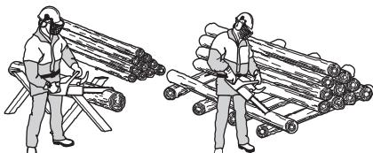
**El tronco en el suelo.** No hay riesgo de atasco de la cadena o de partición del objeto de corte. Sin embargo, hay un riesgo considerable de que la cadena toque el suelo después del corte.
