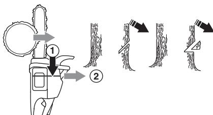
La profundidad del corte de indicación debe ser igual a 1/4 del diámetro del tronco, y el ángulo entre los cortes superior e inferior debe ser de 45° como mínimo.
