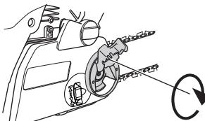
El tensado de una cadena nueva debe controlarse con frecuencia, hasta que se haya hecho el rodaje. Controle el tensado regularmente. Una cadena correcta significa buena capacidad de corte y larga duración.
