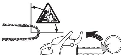
O retrocesso desloca-se sempre na direcção do plano da lâmina. Mais comum é que a moto-serra e a lâmina sejam arremessadas para cima e para trás, contra o utilizador. Entretanto, ocorrem outras direcções de retrocesso, dependendo da posição da moto-serra no momento em
