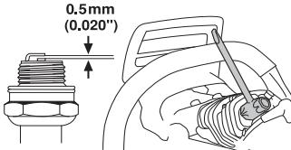
Aclaración! ¡Utilice siempre el tipo de bujía recomendado! Una bujía incorrecta puede arruinar el pistón y el cilindro. Asegúrese de que la bujía tenga supresión de perturbaciones radioeléctricas.
