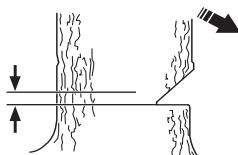
Coloque o apoio para casca (se estiver montado) atrás da linha de ruptura. Serre com aceleração total e deixe a corrente/lâmina penetrar devagar na árvore. Observe se a árvore se move no sentido contrário ao da direcção de queda pretendida. Introduza uma cunha de abate ou barra extractor a logo que a profundidade de corte o permita.
