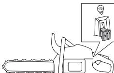
¡ATENCIÓN! El contacto de arranque/parada retorna automáticamente a la posición de marcha. Por consiguiente, para evitar el arranque involuntario hay que quitar siempre el capuchón de encendido de la bujía antes de realizar trabajos de montaje, control y/o mantenimiento.
