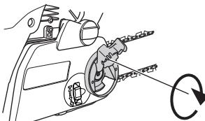
Numa corrente nova, a tensão deverá ser controlada constantemente até concluir a rodagem. Verifique a tensão da corrente regularmente. Uma corrente correcta significa boa capacidade de corte e longa vida útil.
