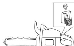
**¡ATENCIÓN!** El contacto de arranque/parada retorna automáticamente a la posición de marcha. Por consiguiente, para evitar el arranque involuntario hay que quitar siempre el capuchón de encendido de la bujía cuando se abandona la máquina.
