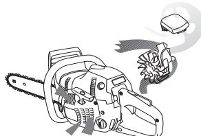
**IMPORTANTE!** Para conservar a função de purificação centrífuga, é necessário prestar assistência e manutenção contínuas. Limpe a entrada de ar do dispositivo de arranque, asas de ventoinha da cambota, compartimento em torno da cambota, tubo de admissão e compartimento do carburador.
