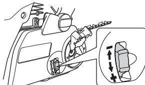
A corrente está correctamente esticada quando não mais estriver frouxa na parte inferior da lâmina e ainda possa ser girada facilmente com a mão. Aperte bem as porcas da lâmina com a chave universal ao mesmo tempo que segura a extremidade da lâmina.
