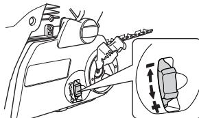
La cadena está correctamente tensada cuando no cuelga en la parte inferior de la espada y puede girarse fácilmente con la mano. Apriete las tuercas de la espada con la llave combinada, sujetando al mismo tiempo la punta de la espada.
