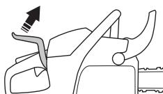
**¡La sierra no se debe llevar ni colgar nunca por/en la horquilla! De hacerlo, puede dañarse el mecanismo, con lo que deja de funcionar el freno de cadena.**
