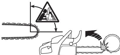
El corte con la parte inferior de la espada, en sentido descendente desde la parte superior del objeto a cortar, se denomina de corte con cadena tirante. La motosierra es tirada hacia el árbol y el canto delantero del cuerpo se apoya contra el tronco. Con esta técnica de cadena tirante, el usuario controla mejor la motosierra y la situación del sector de riesgo de reculada de la espada.
