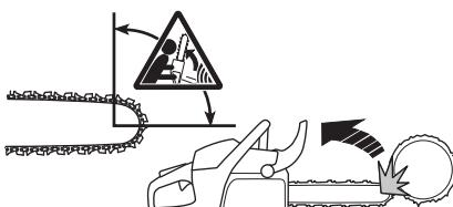
Serrar com a parte inferior da lâmina, ou seja, serrar a partir do lado superior do objecto a ser serrado, e para baixo, chama-se serrar com a corrente a puxar. Então a moto-serra é puxada contra a árvore e o canto anterior do corpo da moto-serra forma um apoio natural contra o tronco. Serração com a corrente a puxar possibilita ao utilizador um melhor controlo sobre a moto-serra bem como sobre onde o sector de risco de retrocesso da lâmina está localizado.
