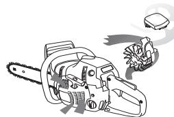
**¡IMPORTANTE!** Para que la depuración centrífuga funcione satisfactoriamente, debe efectuarse un mantenimiento constante del sistema. Limpie la toma de aire del mecanismo de arranque, las palas de ventilador del volante, el espacio alrededor del volante, el tubo de admisión y el compartimiento del carburador.
