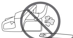
• O travão da corrente deverá estar aplicado quando se dá o arranque à motosserra. Ver instruções na secção Arranque e paragem. Nunca dê o arranque à motosserra segurando a corda do arranque e deixando cair a máquina. Esse método é muito
