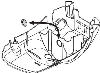
Para utilizar la máquina en climas fríos o con polvillo de nieve, hay una cubierta especial que se coloca sobre el cuerpo del mecanismo de arranque. Se reduce así la entrada de aire frío y se impide la aspiración de grandes cantidades de nieve.
