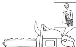
**NOTA!** O interruptor de Arranque/Paragem retorna automaticamente à posição de operação. Por isso, para impedir arranque acidental, deve-se sempre remover o cachimbo da vela de ignição quando a máquina não está sob vigilância.
