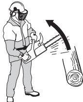
Retrocesso somente pode ocorrer quando o sector de risco de retrocesso da lâmina entrar em contacto com um objecto.
