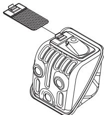
O silenciador é configurado para abafar o nível de ruído e para conduzir os gases de escape para longe do utilizador. Os gases de escape são quentes e podem conter faíscas que podem causar incêndios, se os gases forem dirigidos contra um material seco e inflamável.
