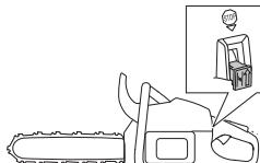
**NOTA!** O interruptor de Arranque/Paragem retorna automaticamente à posição de operação. Por isso, para impedir o arranque acidental da máquina, deve-se sempre remover a protecção da vela de ignição durante todos os trabalhos de montagem, inspecção e/ou manutenção.
