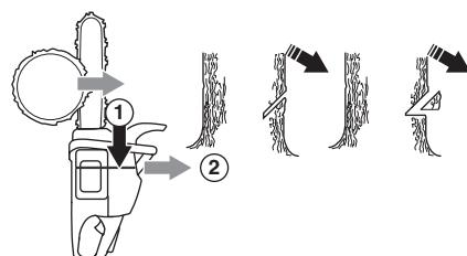
A profundidade do corte direccional deve ser de 1/4 do diâmetro do tronco e o ângulo entre o corte superior e o inferior, no mínimo de  $45^{\circ}$ .
