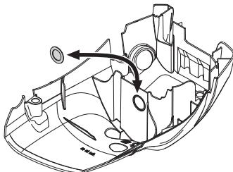
Para operações com a máquina em clima frio ou neve solta, está disponível uma cobertura especial que se monta no compartimento do dispositivo de arranque. Assim reduz-se a entrada de ar frio e impede a sucção de grandes quantidades de neve.
