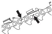
Para comprobar el desgaste de la cadena que utiliza, le recomendamos que la compare con una cadena nueva.
