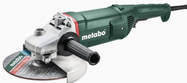
Amoladora 2400 W con robusto motor Metabo, para disco de Ø 9" (230 mm) con carbones autodesconectantes, 6600 rpm y 14 Nm de torque. Arranque electrónico suave y protección contra puesta en marcha involuntaria. Empuñadura adicional y protección de disco regulable.
