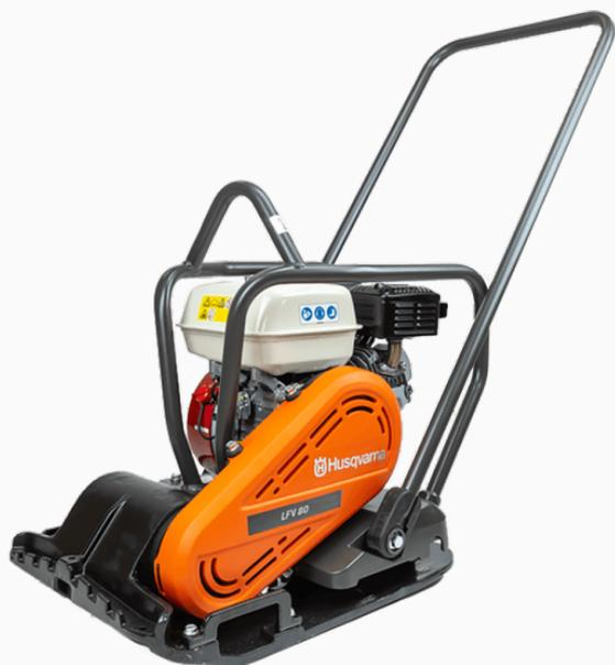
Plancha Compactadora Lfv 80 con Motor HONDA GX160 5,0 HP. Tamaño de la plancha: 42 x 57 cm. Fuerza Centrifuga max. 19,4 kN. Prof. De Compactacion 20 cm. Rendimiento 832 m2/hora. Peso 82 kg. Aplicación: Suelo. (sin tanque de agua)
