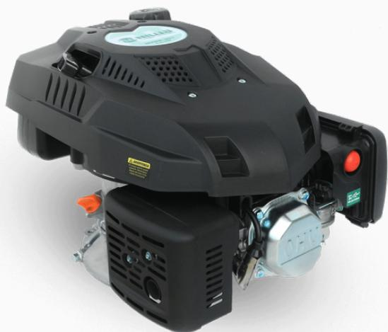
El modelo MVNW-201 pertenece a la línea de motores verticales nafteros, monocilíndrico, 4 tiempos, de la marca Niwa. Se destaca por su fácil arranque y bajo consumo de combustible. Sus características: 6.5 HP / 201 CC, válvulas a la cabeza (OVH) y un gran filtro de aire. Apto para 22 / 55,8 cm de corte. Ideal para motorizar nuestras cortadoras de césped Pampa Pro y otras similares. Mantenimiento de jardines y espacios verdes amplios.
