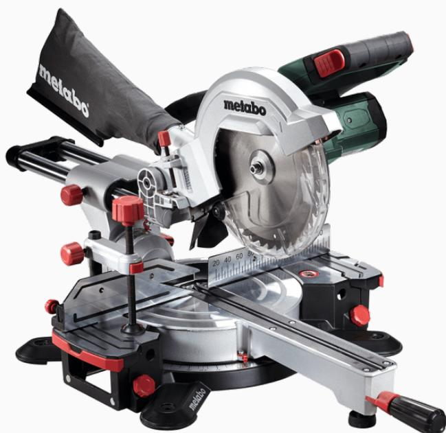
Ingletadora (con función de tracción) a batería 18 V. Hoja de sierra Ø 216 x 30 mm. Capacidad de corte 90°/90°: 305 x 65 mm. Capacidad de corte 45°/45°: 205 x 36 mm. Aspiración de viruta. Laser para indicar línea de corte. Luz LED de trabajo. Pinza para fijación de pieza.
