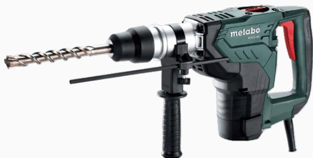
Martillo combinado Metabo KH 5-40, con dos funciones, cincelar y perforar con golpe. Su embrague de seguridad S-automatic permite el desacoplamiento mecánico cuando se bloquea la broca para trabajar de forma segura. Su diseño le confiere una óptima evacuación del calor y durabilidad.
