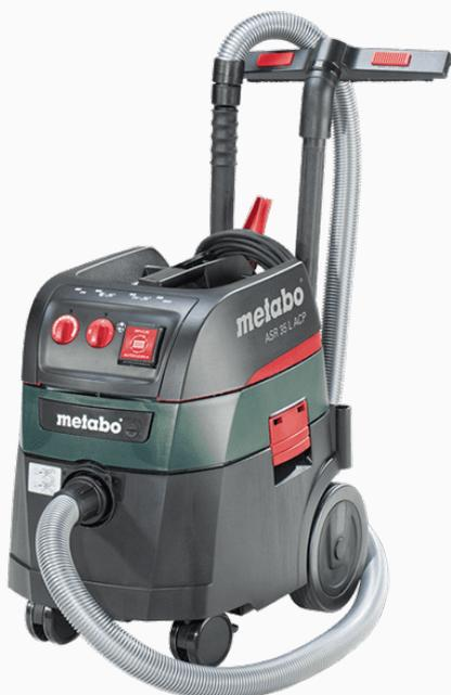
Aspiradora limpieza automática del filtro, garantiza un trabajo sin interrupciones y está perfectamente adaptado a las herramientas Metabo gracias a la conexión automática. Como aspirador de seguridad con certificado de inspección, el ASR 35 M ACP está aprobado para los polvos nocivos de la clase L, M y H. Aspira húmedo y seco. Sistema AutoCleanPlus, filtro MPulse. Si la potencia de aspiración cae, los filtro se sacuden automáticamente.
