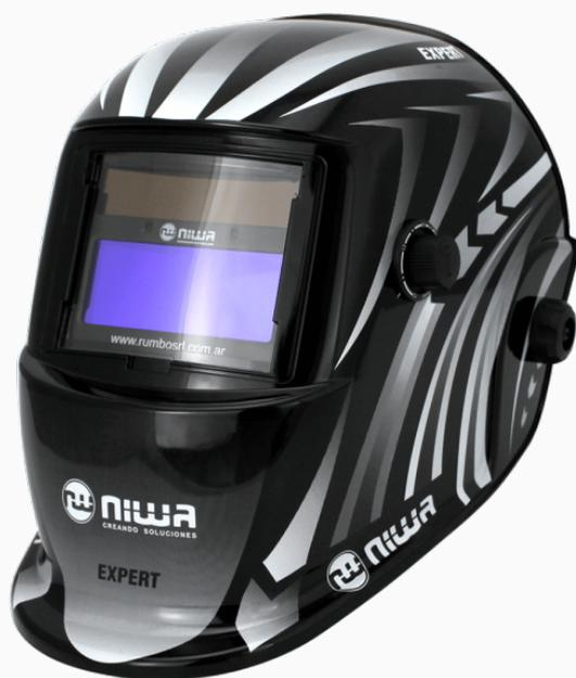
Máscara fotosensible. Con regulación de sensibilidad y tiempo de pasaje de oscuro a claro. DIN regulable 4/9-13. Área de visión 96x39 mm. Carga solar con asistencia de batería. Con modo amolado.
