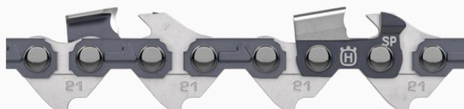
La SP21G es una cadena mini de 1,1 mm de 0,325" con corte semicortante especialmente desarrollada para aumentar la velocidad de corte y la eficiencia de las motosierras a batería de uso permanente. La cadena es energéticamente eficiente y la geometría optimizada ofrece un corte uniforme, un excelente corte de perforación y un manejo y una maniobrabilidad mejorados.
