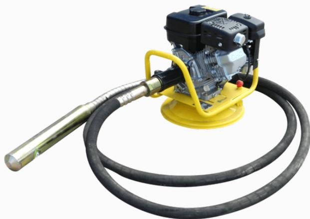
Esta unidad motriz con motor Honda GX160 5,5Hp y 3000 RPM para vibradores de inmersión, es la que ofrece la mejor relación costo/prestaciones. Tiene conexión Dynapac apta para cabezales de 38/ 45 / 50 / 70 mm, así como también para las bombas sumergibles Niwa.
